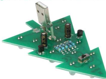
**H** Nach der Wahl der richtigen Platzierung USB-Stecker verlöten. Erst nur eine Lötstelle leicht anlöten, USB-Stecker ausrichten (wenn dieser schräg steht) und dann die restlichen 3 Lötstellen anlöten. Nur wenn alle 4 Lötstellen gelötet wurden, ist eine gute Stabilität des USB-Steckers gewährleistet.
